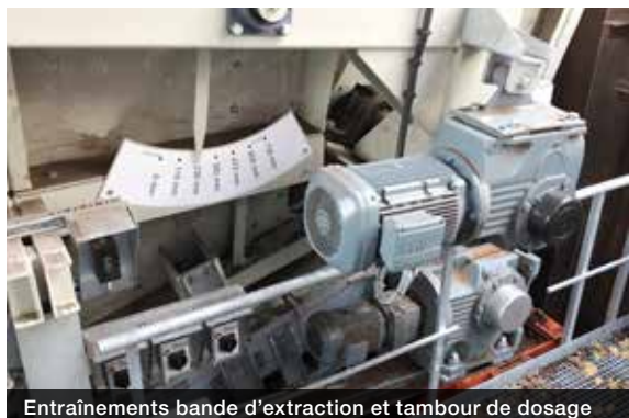
Entraînements bande d'extraction et tambour de dosage
