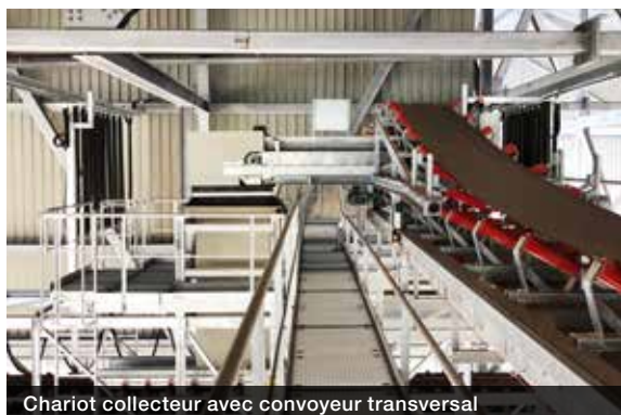
Chariot collecteur avec convoyeur transversal
