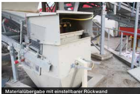
Materialübergabe mit einstellbarer Rückwand
