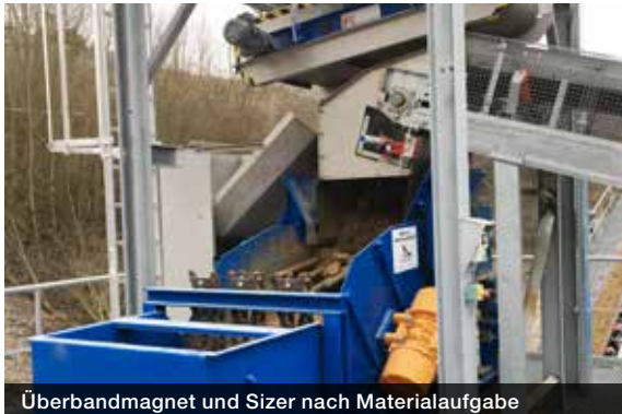
Überbandmagnet und Sizer nach Materialaufgabe
