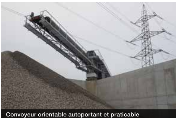
Convoyeur orientable autoportant et praticable
