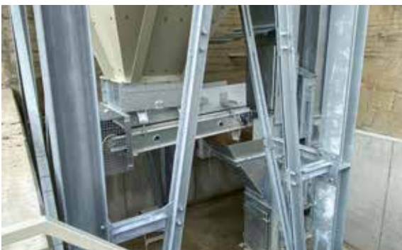
Dosiergerät mit Bandbreite 650 mm und Becherwerkfuß
