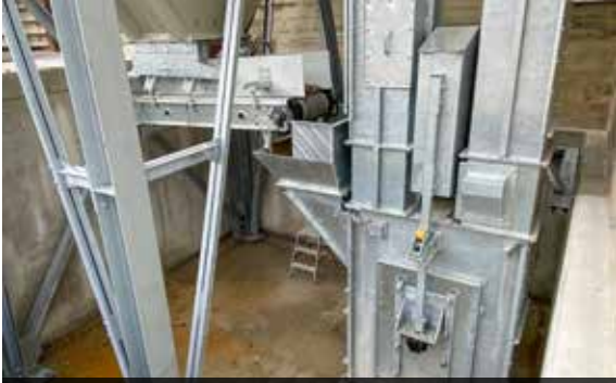
Dosiergerät mit Bandbreite 650 mm und Becherwerkfuß
