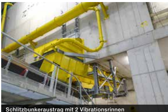
Schlitzbunkeraustrag mit 2 Vibrationsrinnen
