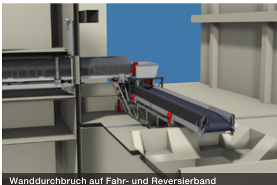
Wanddurchbruch auf Fahr- und Reversierband
