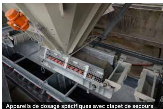
Appareils de dosage spécifiques avec clapet de secours
