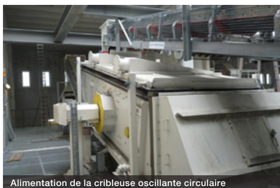
Alimentation de la cribleuse oscillante circulaire
