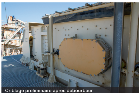
Criblage préliminaire après débourbeur
