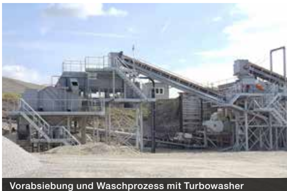
Vorabsiebung und Waschprozess mit Turbowasher
