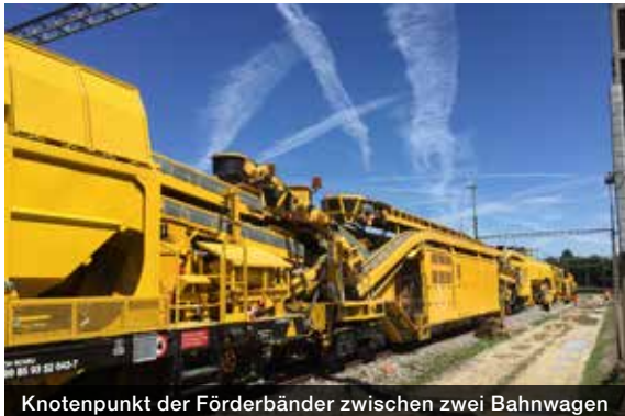
Knotenpunkt der Förderbänder zwischen zwei Bahnwagen
