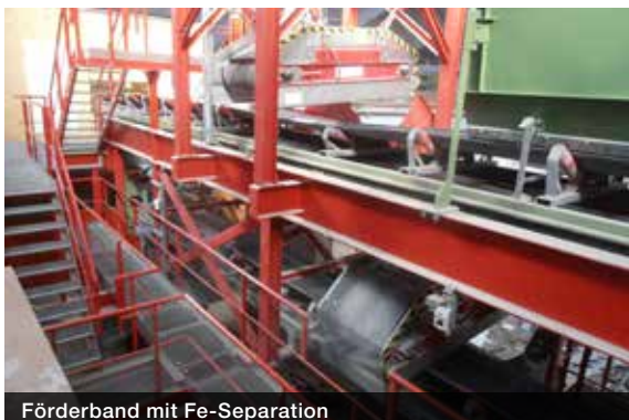
Förderband mit Fe-Separation
