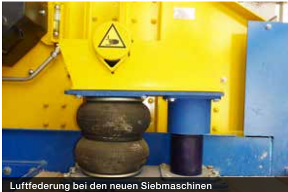
Luftfederung bei den neuen Siebmaschinen
