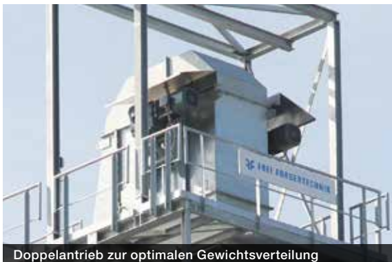
Doppelantrieb zur optimalen Gewichtsverteilung
