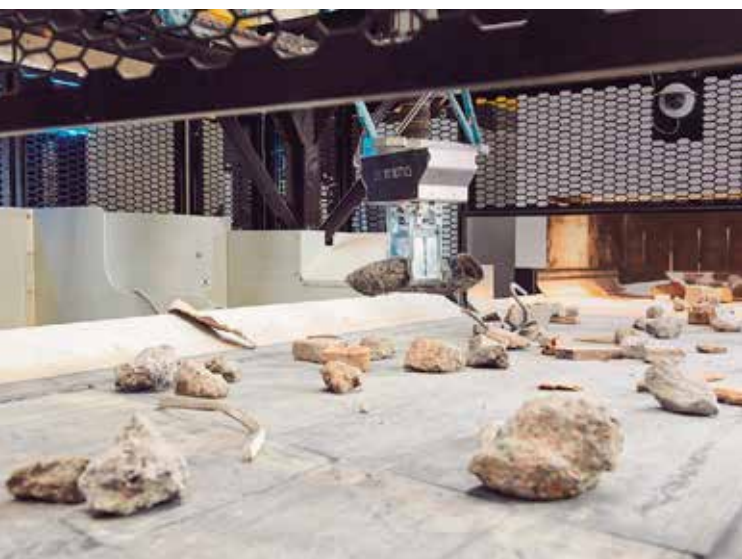
5 Mit künstlicher Intelligenz werden die Materialien über vier Sensorboxen erkannt Artificial intelligence recognises the materials via four sensor boxes
