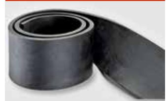
Guidage latéral en caoutchouc 50° shore, H: 10 mm L: 25000 mm l: 80, 100, 120, 150, 200 mm ou bien sur demande
